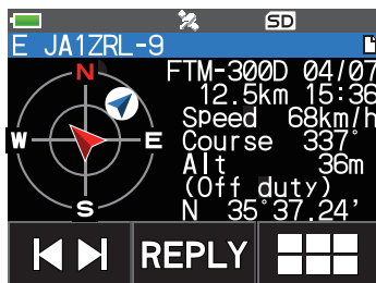
Exemple d'affichage lorsqu'un signal APRS est reçu
