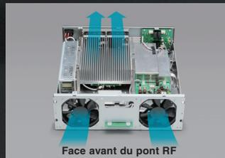
Système de refroidissement à quatre ventilateurs
