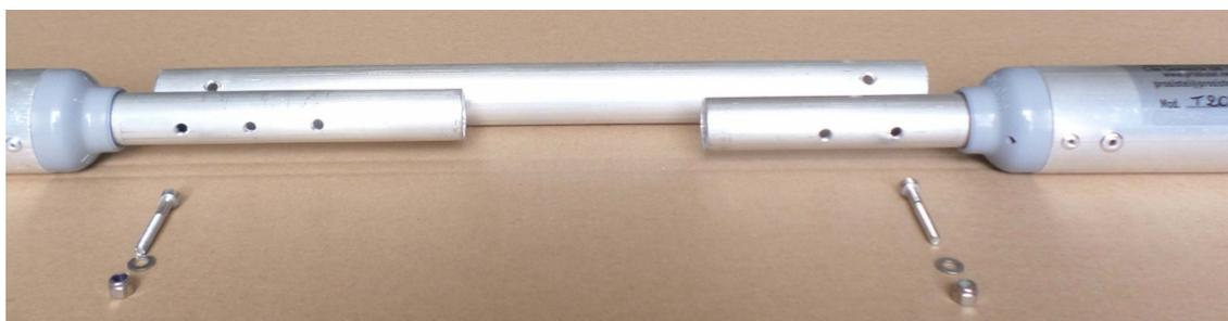
**En allongeant l'antenne, on diminue la résonance, en la raccourcissant, on l'augmente.** Les décalages effectués affectent en conséquence les bandes inférieures suivantes. Commencez **toujours l'étalonnage à partir de la fréquence la plus élevée.**
