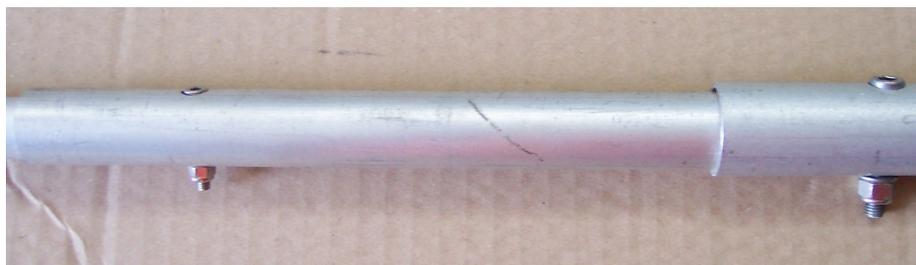
Serrez l'écrou. Veillez à ce que toutes les têtes de goupilles soient du même côté, la tête vers le haut. En utilisant la même technique, retirez et joignez toutes les sections.
