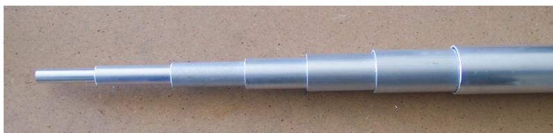
Placez le demi-dipôle sur un plan et commencez à extraire le plus petit diamètre, Faire correspondre le trou du tube intérieur avec celui du tube extérieur. Les éléments sont fixés en insérant le boulon du côté du trou le plus grand, de sorte que la tête cylindrique de la goupille soit bien enfoncée et repose sur le tube intérieur (fig.2).
